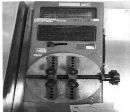
**Gambar 4.1** Alat Uji Kekuatan Tutup Botol Torquemaster
